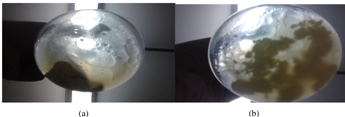
Figura 1 – Gordura de frango liquefeita durante o processo fermentativo de resíduo graxo de frango
