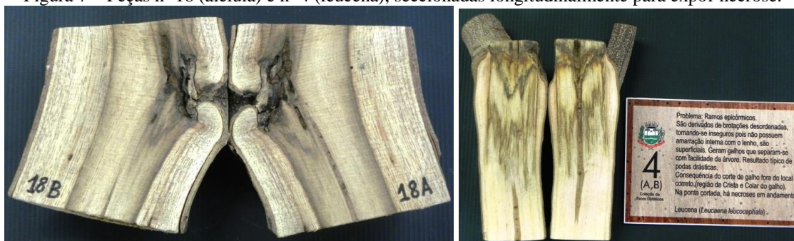
Figura 7 – Peças nº 18 (aleluia) e nº 4 (leucena), seccionadas longitudinalmente para expor necrose.
