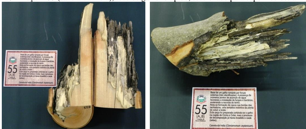
Figura 9 – Peça nº 55 (canela-da-índia), toco de galho rompido, seccionado para expor necrose avançada.
