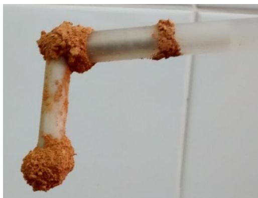
Figura 2-Catalisador heterogêneo Si/KI- \text{Fe}_2\text{O}_3 aderido à barra magnética utilizada para agitação da mistura reacional.
