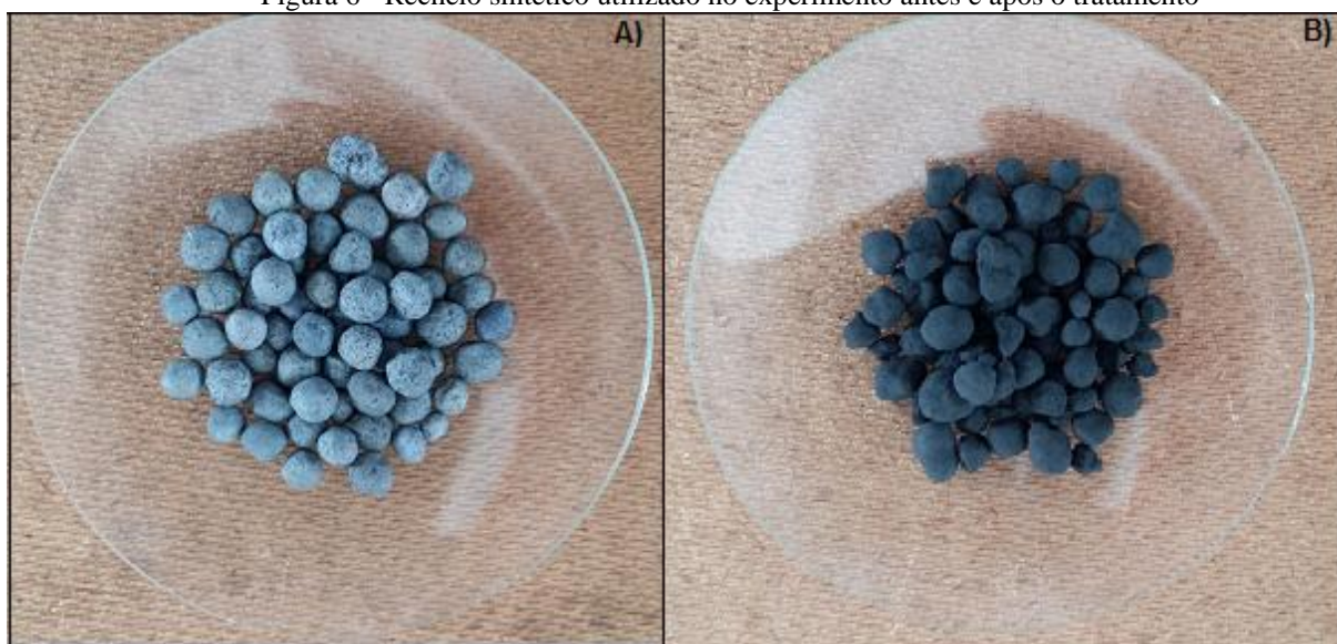
Figura 6 - Recheio sintético utilizado no experimento antes e após o tratamento
