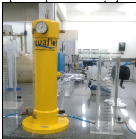
Figura 4 - Aparato experimental para teste de Flotação por Ar Dissolvido (FAD).
