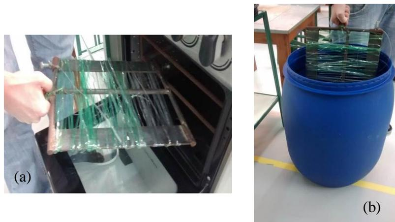
**Figura 7.** Imagens (a) Aquecimento do fio de PET (b) Imersão da grelha em água.
