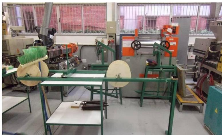
**Figura 2.** Equipamentos utilizados na produção de vassouras PET
