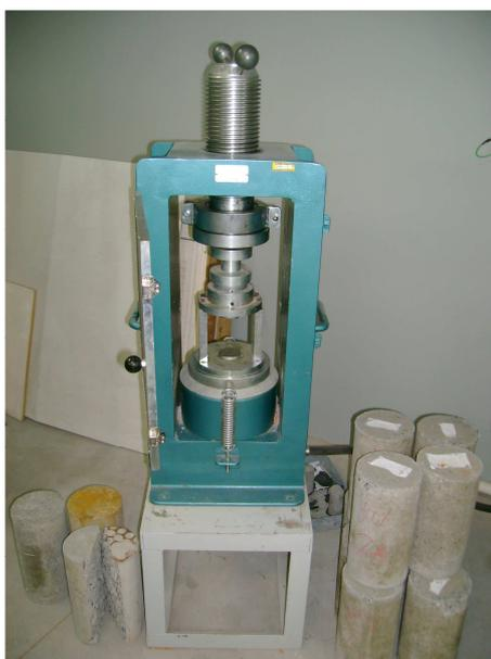
Figura 3. Prensa hidráulica - Pavitest Servi.
